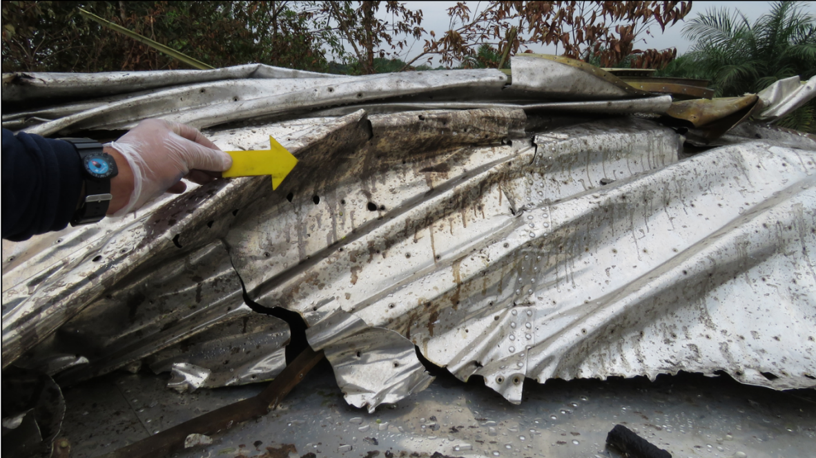
Fotografía No. 1 – Presencia de aceite en la sección del borde de ataque y extradós restos HK2494
