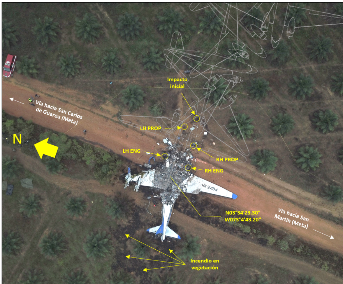
Imagen No. 3 – Escena del accidente y ubicación de los componentes principales de la aeronave. La marca de agua describe la dinámica más probable de impacto contra el terreno.
